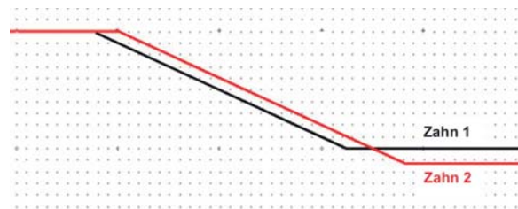
Bild 5: Erzeugung eines scharfkantigen Konkavknicks:
